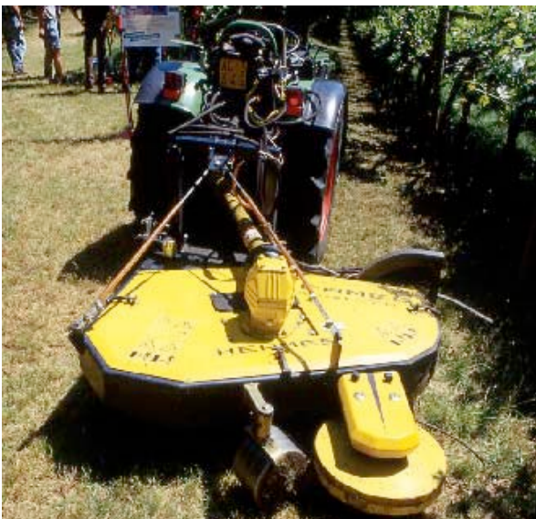
Trinciaerba a coltelli con dispositivo di rientro lungo la fila
